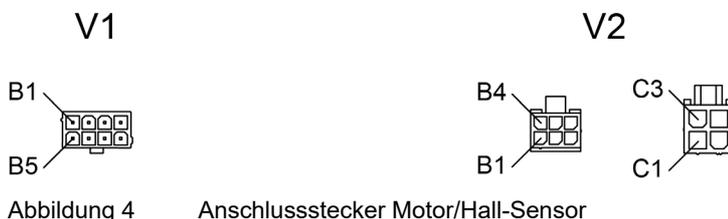
Abbildung 4 Anschlussstecker Motor/Hall-Sensor
