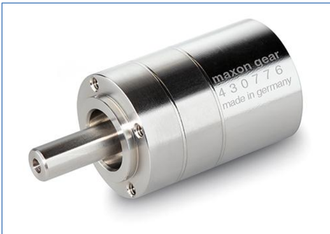
Abbildung 2: Sterilisierbares Planetengetriebe GP 19 M mit zulässigem Dauerdrehmoment 0.315 Nm und für geeignet für eine Motordrehzahl von 40 000 rpm.
