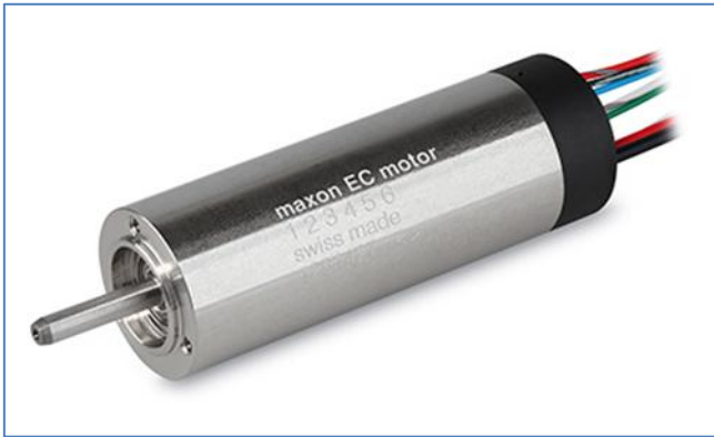
Abbildung 1: Bürstenloser (BLDC) Motor EC 19 High Power 120 Watt. Durchmesser 19mm, Länge 58 mm, mit oder ohne Hall-Sensoren.
